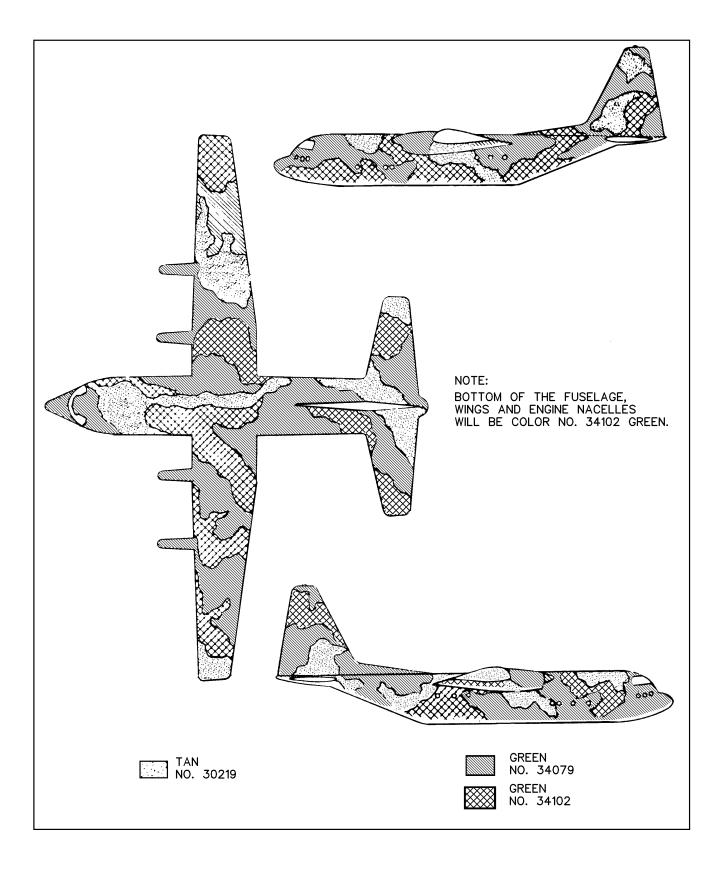
Figure D-6. C-130 Aircraft Camouflage Pattern
