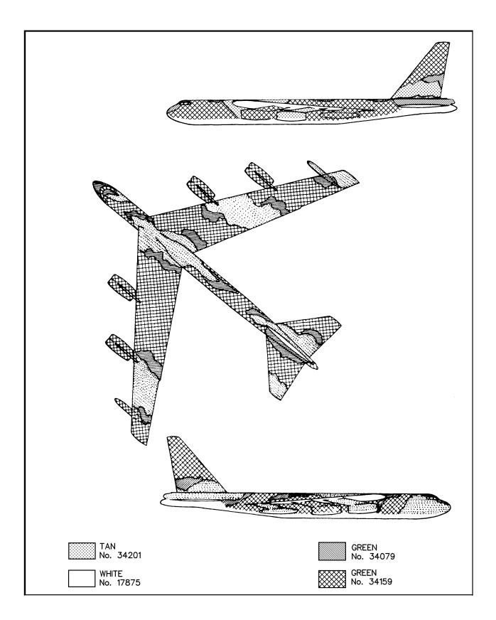
Figure D-3. B-52 Aircraft Camouflage Pattern
